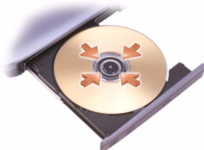
3 将光盘放置在托盘中间（带标签的一面朝上），并将其卡到轴上。
