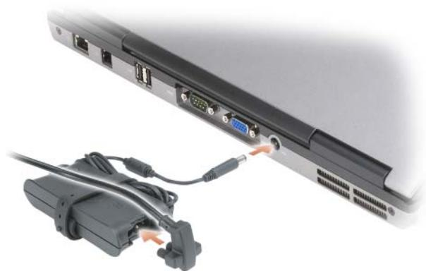
交流适配器将交流电源转换为计算机所需的直流电源。无论计算机处于打开或关闭状态，您均可以连接交流适配器。
