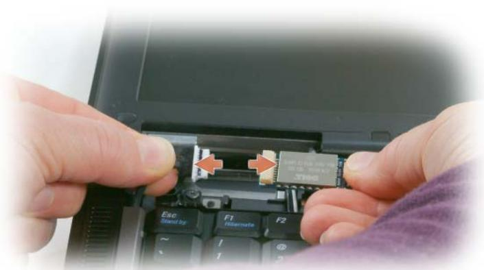
**6** 断开插卡与其电缆的连接，将其从计算机中卸下。
