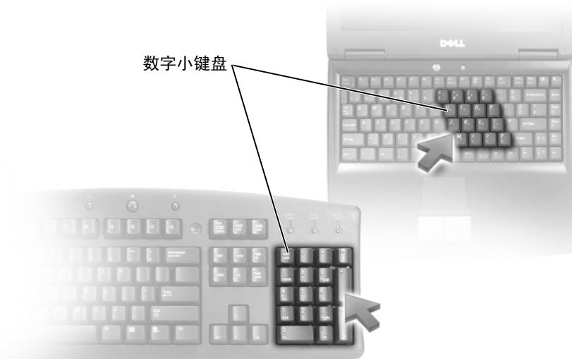
数字小键盘的功能类似于外部键盘上的数字小键盘。小键盘上的每个按键均有多种功能。小键盘上的数字和符号以蓝色标记，位于小键盘按键的右侧。要键入数字或符号，请按住 **<Fn>** 键并按所需按键。
