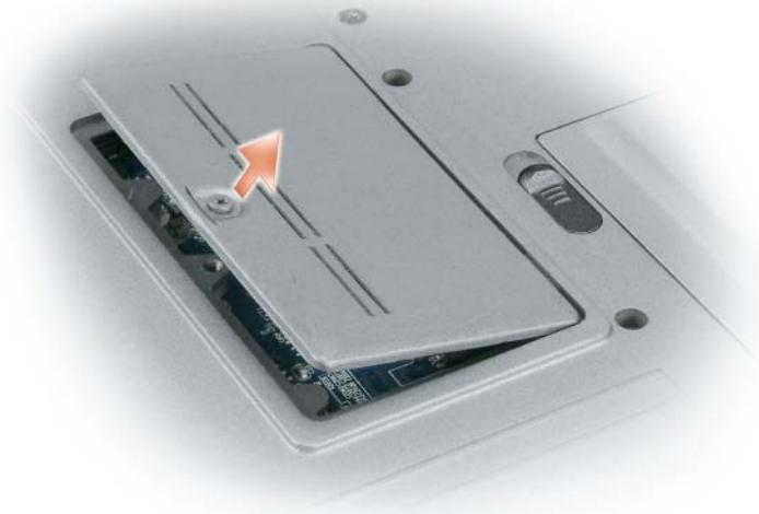
**内存模块护盖** — 用于保护安装第二个内存模块连接器 (DIMM B) 的凹槽（请参阅第 130 页的“内存”）。
